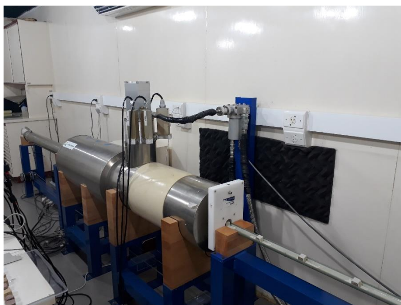
Figura 17 – Magnetômetro criogênico supercondutor Long Core 2G Enterprises para medição da intensidade da magnetização e para desmagnetização por campo alternado.
