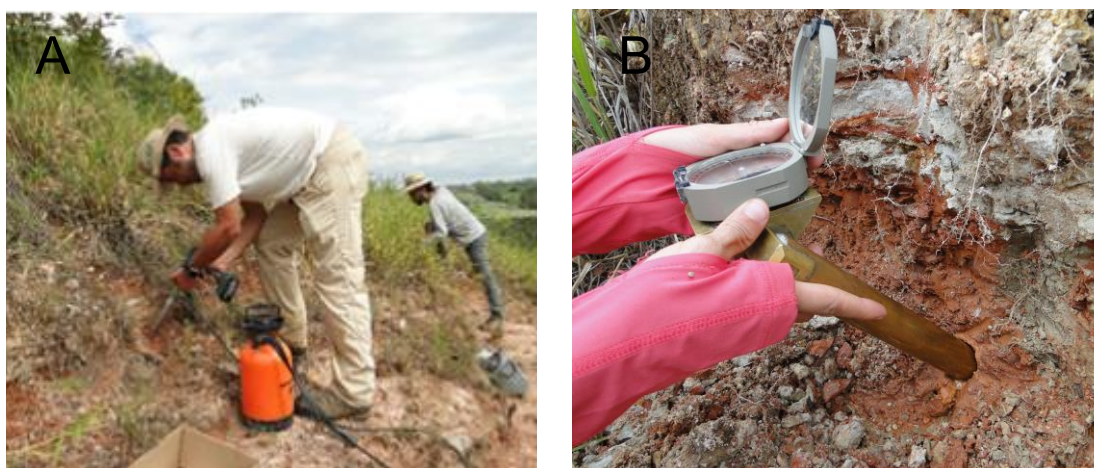
Figura 16 – (A) Amostragem na seção RIO com furadeira elétrica portátil. (B) Orientação da amostra a partir da horizontal com auxílio de um orientador de bronze (que não interfere na agulha magnética da bússola). Fotos: Rosemarie Rohn e a autora.
