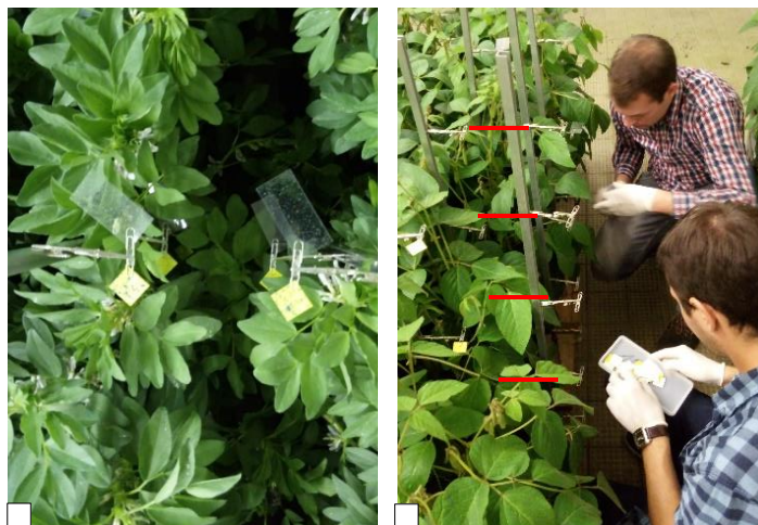
Figura 14A. Disposição de coletores para a determinação de depósitos e cobertura na cultura da fava e soja em experimentos laboratoriais, com detalhe para as alturas de posicionamento dos coletores (B) para cobertura (papel hidrossensível) e depósitos (cartão de poliéster) Fonte: o autor.
