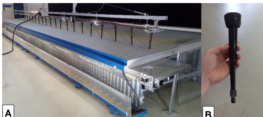
Figura 9A. Mesa de distribuição em configuração para a determinação da vazão das pontas. B. Adaptador para concentração do jato de pulverização em uma única aleta coletora. Fonte: o autor.
