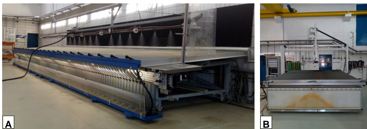
Figura 5. Mesas de distribuição volumétrica, sendo A com avaliação simultânea de todos os exemplares de cada modelo de ponta de pulverização e B com avaliação de cada exemplar de forma isolada. Fonte: o autor.
