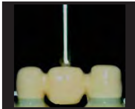
Figura 11 - PPF durante o ensaio de resistência à fratura. Carga sendo aplicada na região central do pântico.
