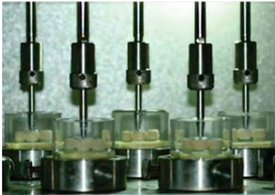
Figura 10 - Ciclagem mecânica das amostras.
