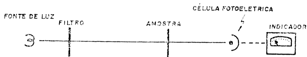
Figura 1 — Esquema de um densitômetro de transmissão.
