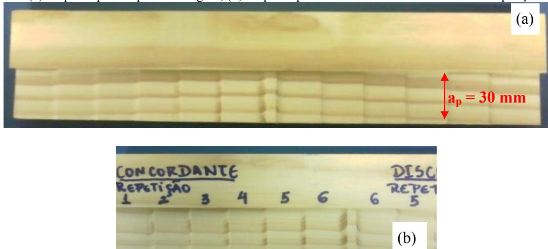
Figura 42 - (a) corpo de prova após a usinagem; (b) corpo de prova com os sentidos de corte e as repetições.
