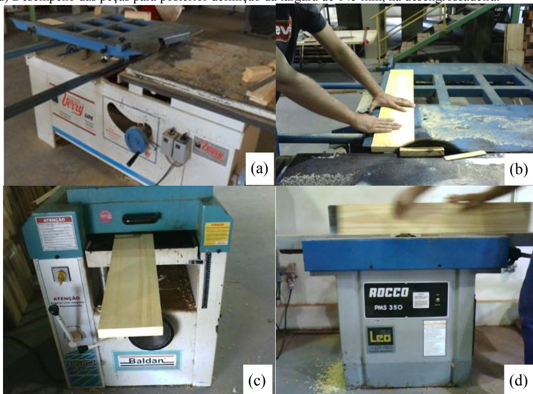
Figura 29 - (a) Esquadrejadeira; (b) Obtenção do comprimento de 990 mm; (c) Obtenção da espessura de 23 mm; (d) Desempeno das peças para posterior definição da largura de 145 mm, na desengrossadeira.
