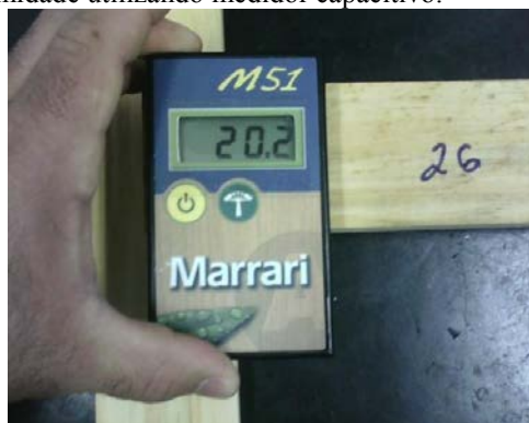
Figura 35 - Medição do teor de umidade utilizando medidor capacitivo.
