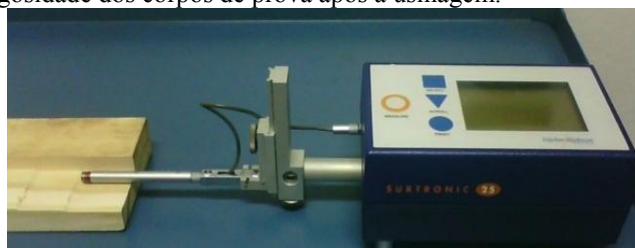
Figura 46 - Medição da rugosidade dos corpos de prova após a usinagem.
