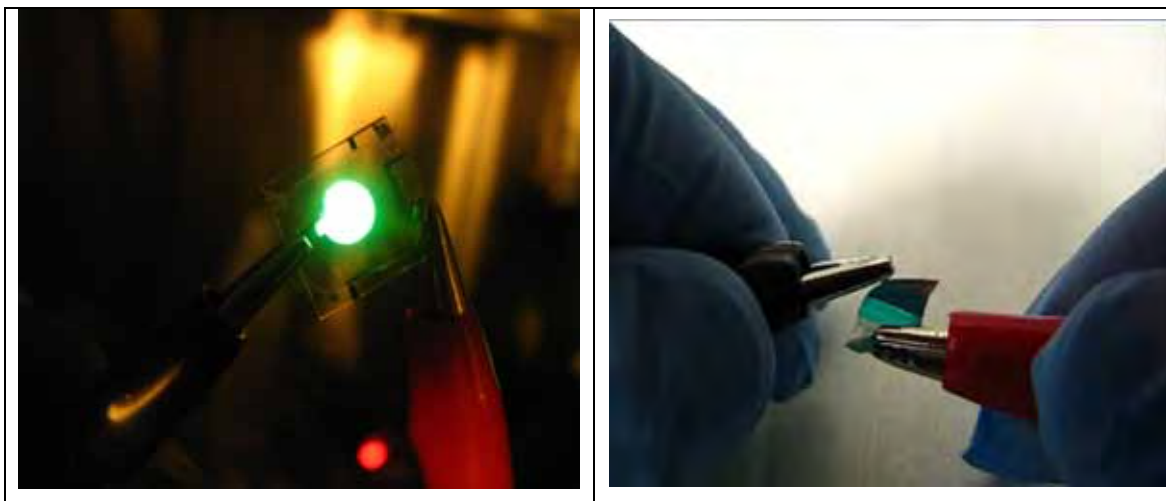
Figura 54 - (a) Eficiência versus densidade de corrente para OLED vidro e FOLED de CB; (b) Eletroluminescência do FOLED depositado sobre o HOI flexível e opticamente transparente baseado em CB/Boe-GPTS.
