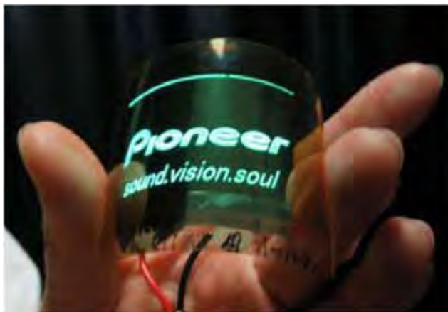
Figura 20 - Eletroluminescência de um OLED depositado sobre o nanocompósito opticamente transparente, flexível e com baixo CET baseado em CP.
