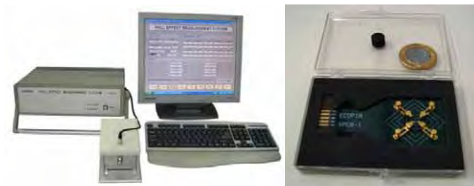
Figura 32 - Equipamento de medida e porta amostra para medidas de efeito Hall da ECOPIA Hall Effect Measurement System HS 3000
