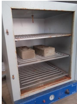
Figura 13 - Tijolos dentro da estufa antes de medida sua massa seca.
