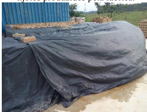
Figura 7 - Sistema desenvolvido para a cura dos tijolos produzidos pela fábrica.
