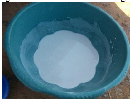
Figura 5 - Escória diluída em água.
