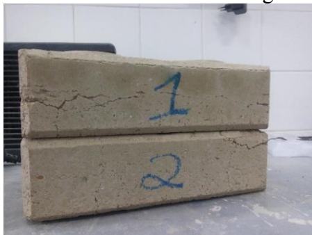
Figura 9 - Detalhe das trincas longitudinais.
