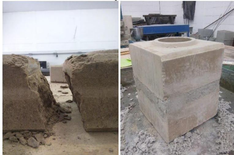
Figura 11 - Detalhe dos dois tijolos separados para o ensaio de compressão.
