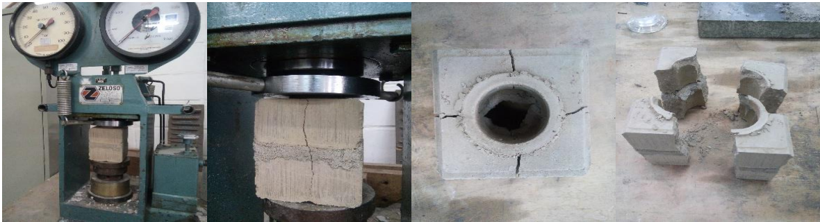
Figura 12 - Etapas do ensaio de compressão e detalhe da fratura no tijolo, causada pela propagação de 4 trincas.
