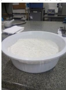
Figura 2 - Escória de alto forno moída em detalhe, após ela passar por 7 dias de moagem em moinho de esferas.
