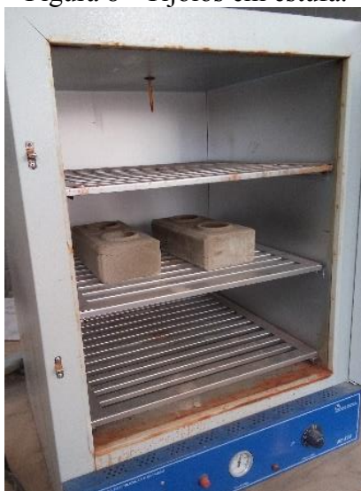
Figura 8 - Tijolos em estufa.
