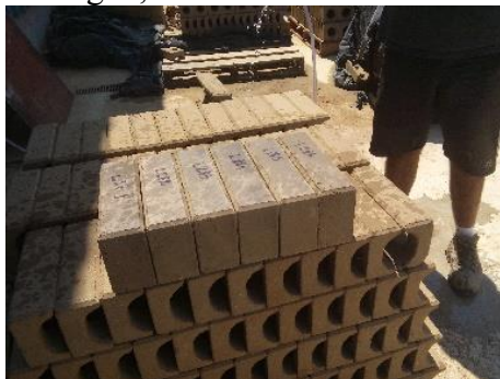
Figura 6 - Em destaque, os 6 tijolos fabricados com o traço de 90% argila, 5% escória e 5% cimento.
