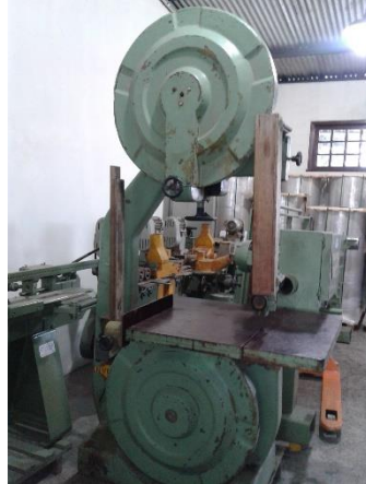
Figura 10 - Representação da serra de fita de bancada, semelhante à utilizada para cortar os corpos de prova para o ensaio de compressão.
