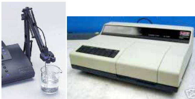
Figura 5- Equipamentos utilizados para a mensuração de (a) \text{Ca}^{+2} e (b) \text{PO}_4^{3-}
