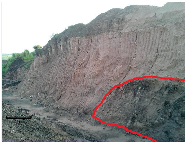
Figura 4: Minério maciço, compacto, sem estrutura visível, aflorante na frente de lavra. Fonte: Arquivo pessoal.
