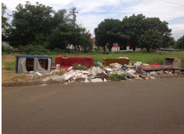
Figura 3.1 - Deposição ilegal de entulhos e RCD em via pública na cidade de São Carlos, SP.
