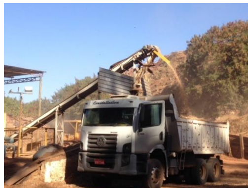
f) esteira rolante com cavacos de madeira
