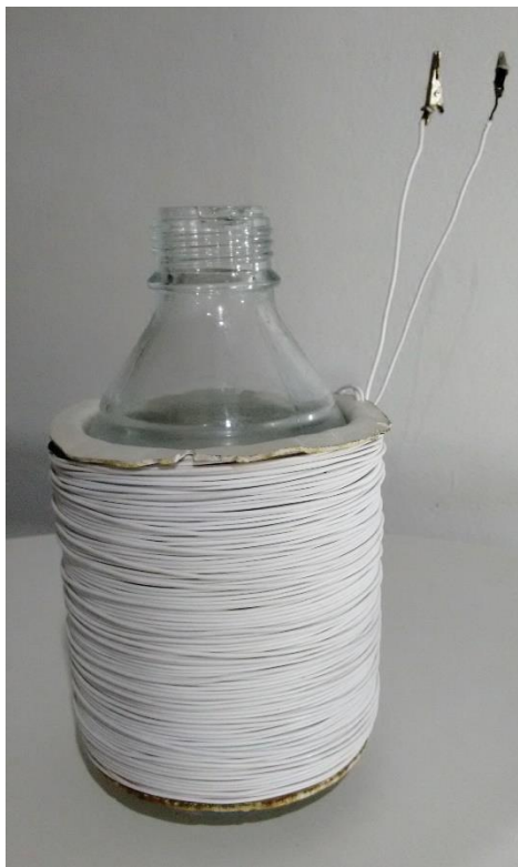
Figura 9 – Reator no interior da bobina
