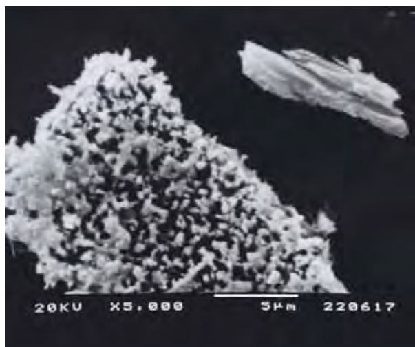
Figura 5. 15: Fotomicrografia do Y(DPP)_3:Eu10\% obtido via síntese hidrotérmica a partir de KDPP ( 180^\circ C/24h ) e ampola em “U”.
