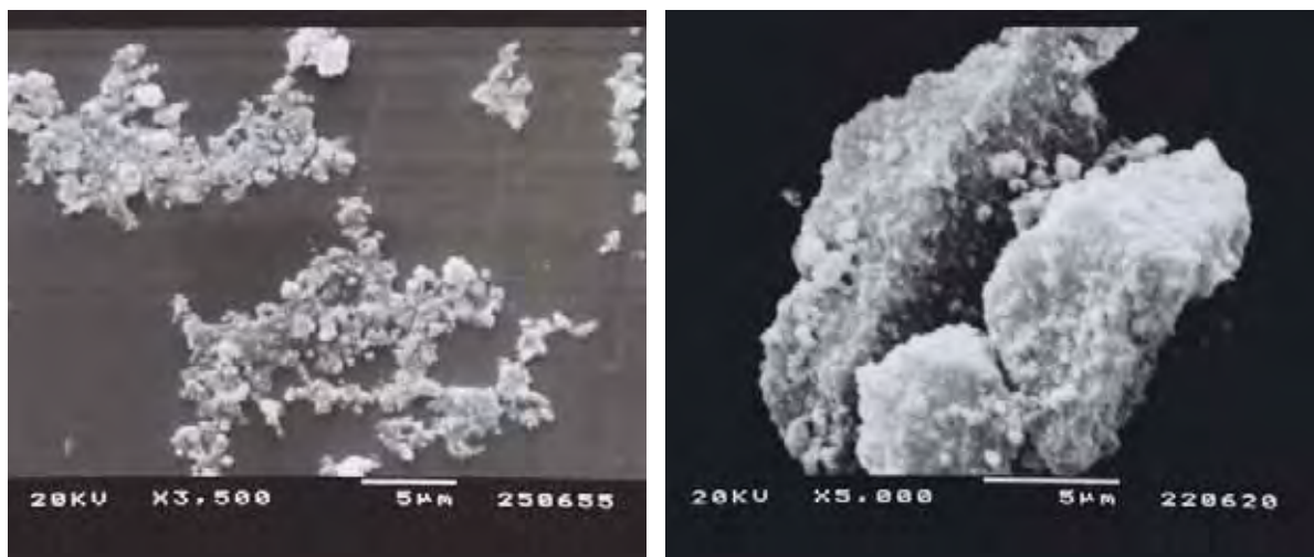
Figura 5. 13: Fotomicrografia do Y(DPP)_3:Eu10\% obtido através de reação de precipitação, T=40^\circ C .
