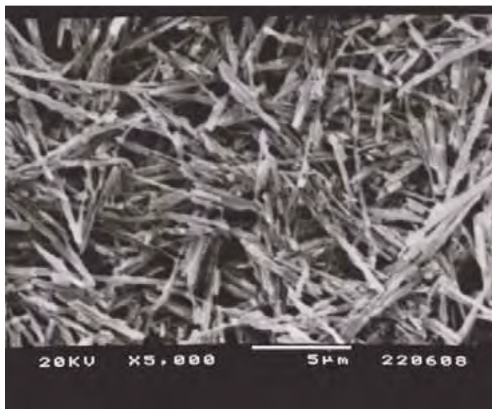
Figura 5. 19: Fotomicrografia do Y(DPP)_3:Eu1\% obtido via síntese hidrotérmica em meio acético, 180^\circ C/24h , ampola simples.
