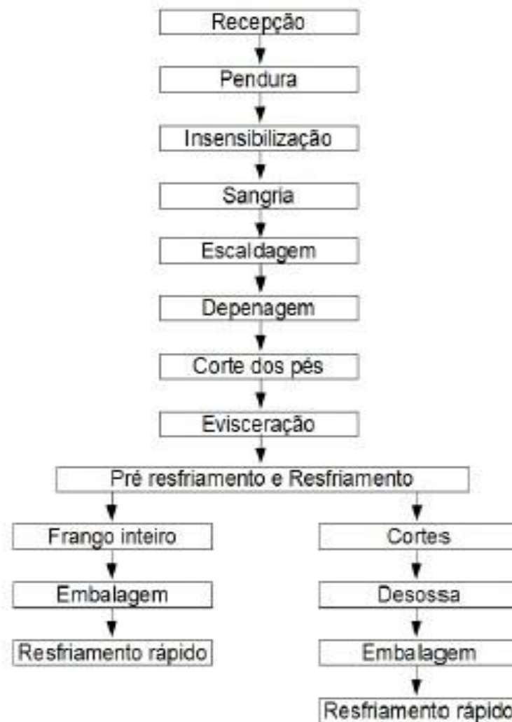
Figura 20 - Fluxograma do abate de aves
