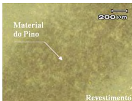
Figura 43 - Microscopia óptica com ampliação de 37,5x da trilha de desgaste formada no ensaio pino-sobre-disco, em amostra tratada com PEO por 600 s, revestimento com 7,5 \mu\text{m} de espessura.
