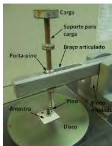
Figura 19 – Foto do compartimento de teste do equipamento pino-sobre-disco.
