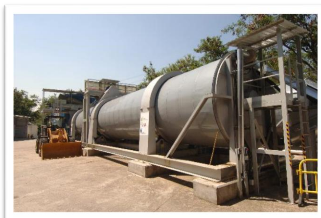
Figura 8: Compostagem através de sistemas fechados ou reatores biológicos ( in-vessel ).
