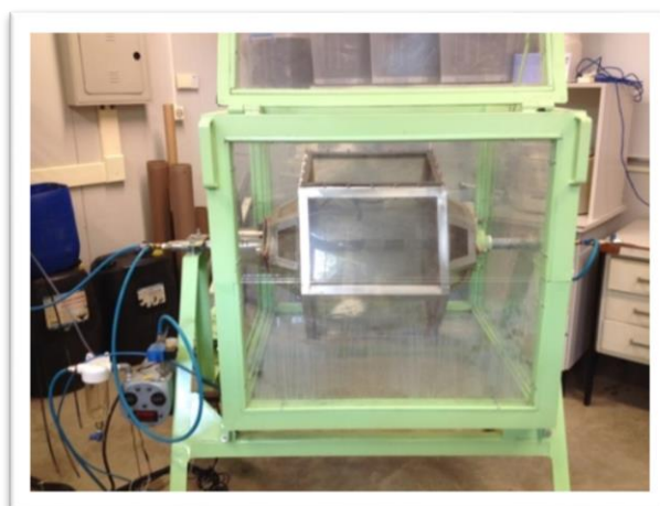
Figura 11: Tambor rotativo no interior da caixa termorreguladora.
