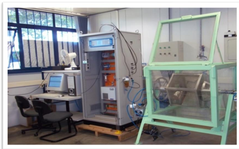
Figura 10: Estrutura geral do processo de análise de compostagem, formada basicamente por tambor rotativo, analisador de gases e aquisição de dados.
