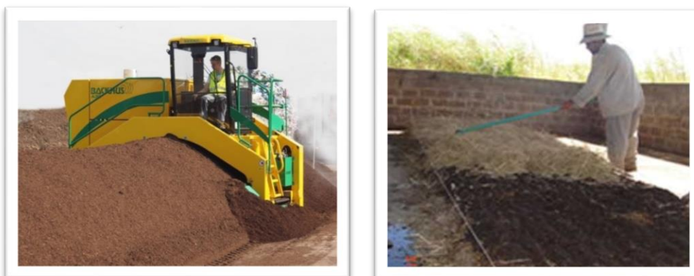
Figura 6: Sistemas de leiras revolvidas, por máquina (esquerda) e manual (direita).
