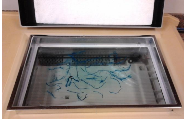
Figura 1. Scanner com a cuba de acrílico contendo as raízes de milho para análise de morfologia radicular
