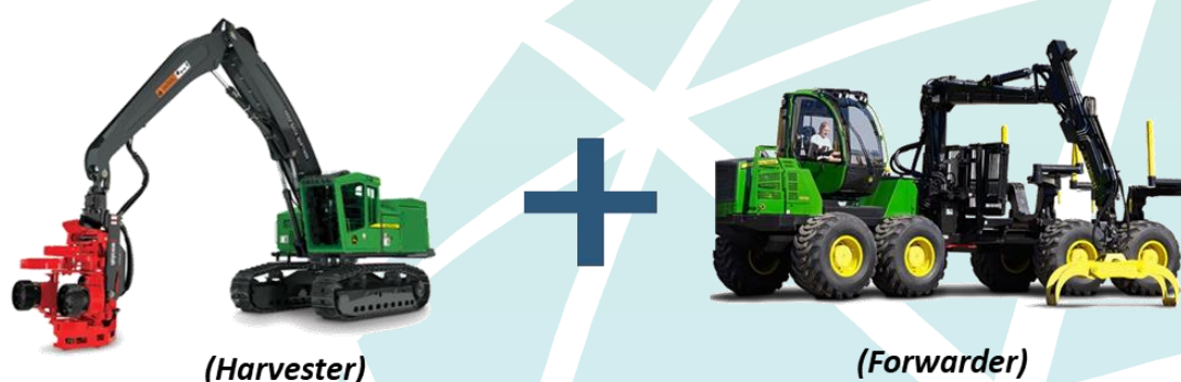
Figura 1: Exemplo de combinação de máquinas para colheita no sistema de toras curtas
