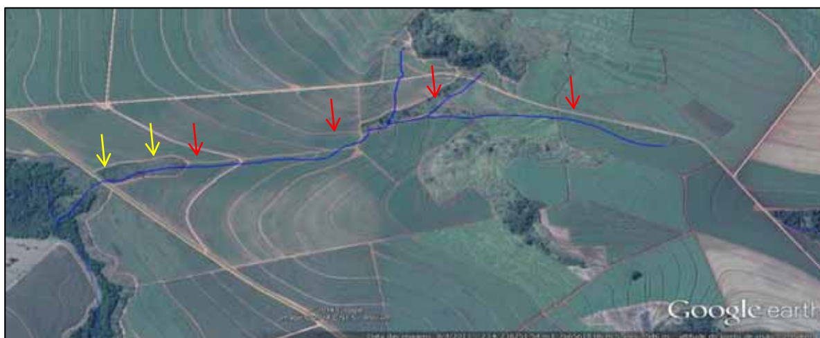
Figura 24. Rede de drenagem superficial degradada (setas vermelhas) no qual houve o afloramento de água e necessidade de reflorestamento (setas amarelas).
