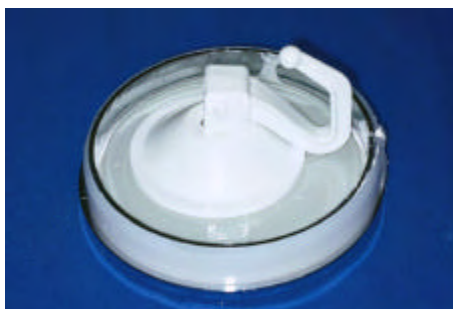
FIGURA 7 – Compressão suave do gesso especial (Vita) com placa de vidro.
