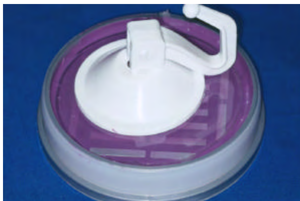
FIGURA 10 – Compressão do material de moldagem com placa de vidro
