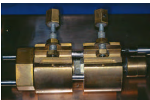
FIGURA 17 – Dispositivo de fixação de barras.
