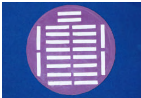
FIGURA 12 – Molde com aberturas na base e no topo.
