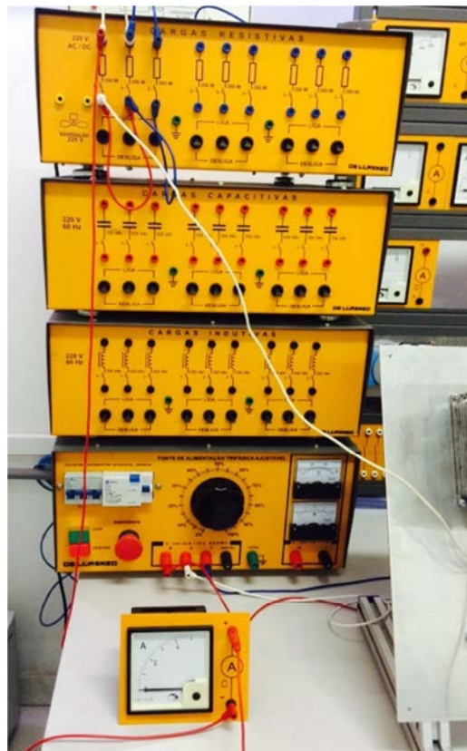
Figura 28: Aspecto do banco de resistências conectado ao chopper do inversor.
