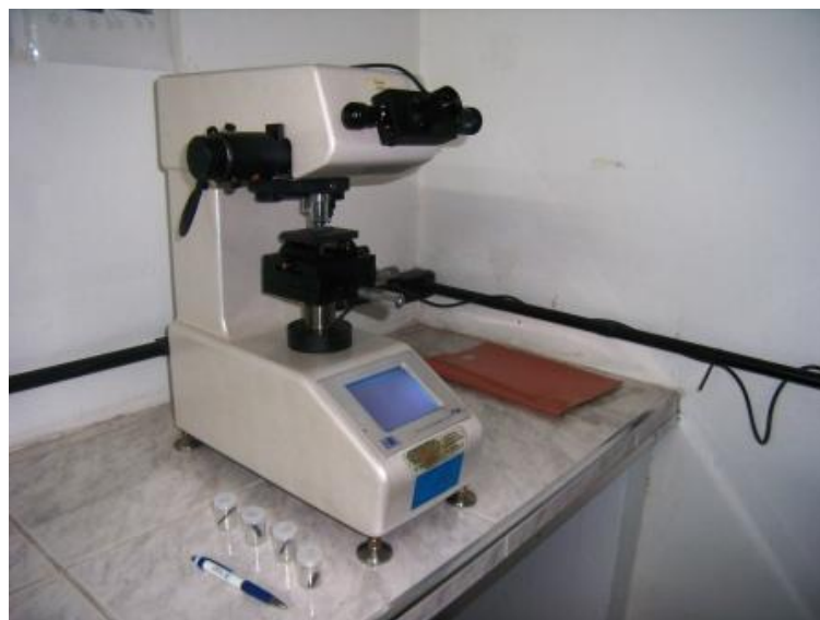
Figura 31 – Equipamento utilizado no ensaio de dureza Vickers
