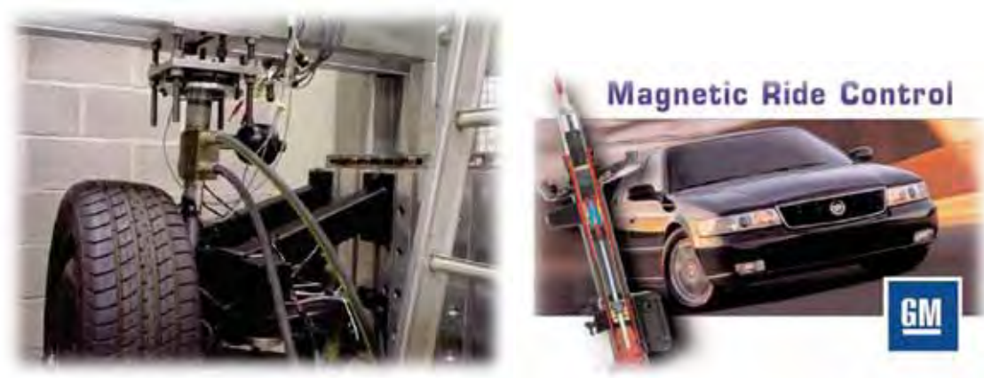
Figura 1.2 - Aplicação experimental de um quarto de suspensão com amortecedor MR (LAUWERYS et al., 2002) e detalhe do amortecedor MR na propaganda do Cadillac Seville STS 2002.
