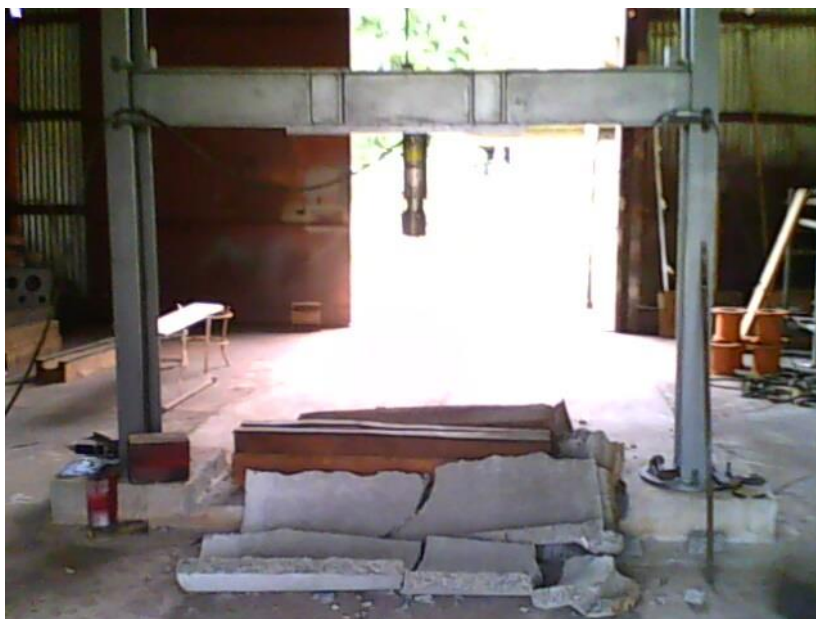
Figura 38 - Tubo de concreto reforçado com resíduo de borracha após a ruptura brusca
