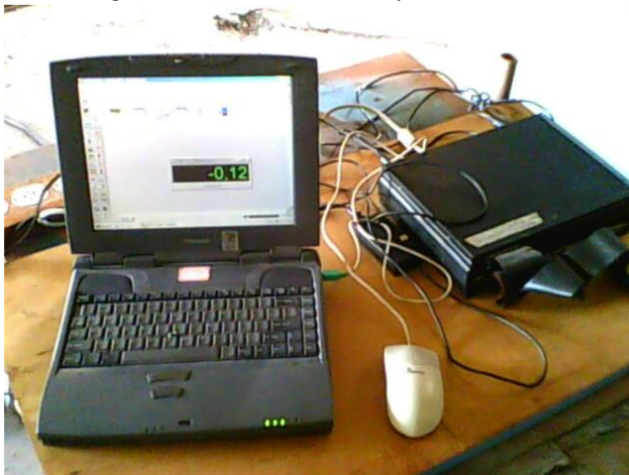
Figura 34 - Sistema de aquisição de dados da marca Iotech (Daqbook 120), conectado a um microcomputador através do software DasyLab (versão 6.0)
