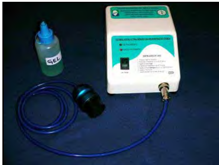
Figura 4 - Imagem fotográfica do aparelho de ultrassom pulsado de baixa intensidade, cedido gentilmente pelo Programa de Pós Graduação Interunidades em Bioengenharia, da Escola de Engenharia de São Carlos – Universidade de São Paulo (USP).
