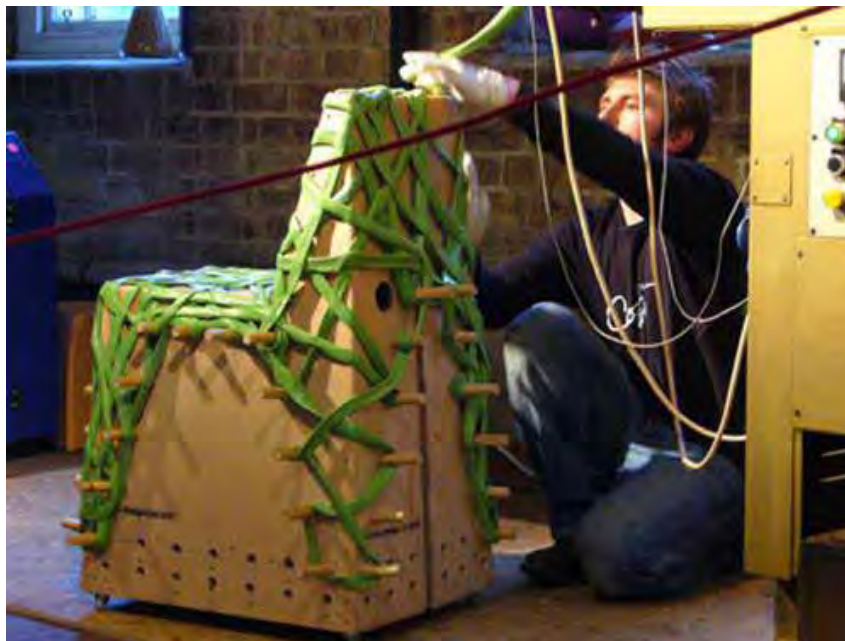
Figura 7: Processo de construção da cadeira reciclada da empresa inglesa Cohda Design Disponível em: http://www.casabrasil.com.br/blog/2011/lixo-inspirador/ Acessado em: 29 de outubro de 2012
