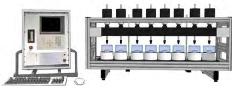
Figura 11 – Aparelho de mastigação (Chewing Simulator CS-3) usado para aplicar carga sobre os espécimes.
