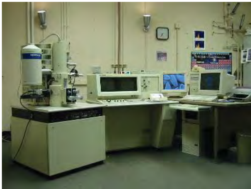
Figura 8 – Microscópio Eletrônico de Varredura por Emissão de Campo utilizado para análise da morfologia do esmalte e da dentina.
