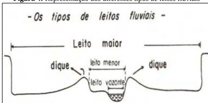
Figura 4: Representação dos diferentes tipos de leitos fluviais
