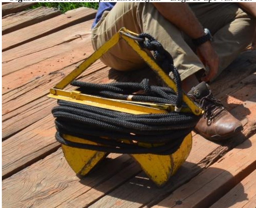
Figura 18: Instrumento para amostragem – draga do tipo van veen
