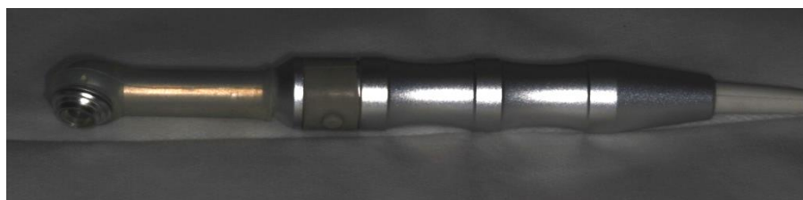
Figura 4. LED (Kon-lux, 600\text{ mW/cm}^2 , Kondortech Equipamentos Odontológicos Ltda., São Carlos, SP, Brasil). (Fonte: Laboratório de Microbiologia do Departamento de Periodontia da Faculdade de Odontologia de Araçatuba).
