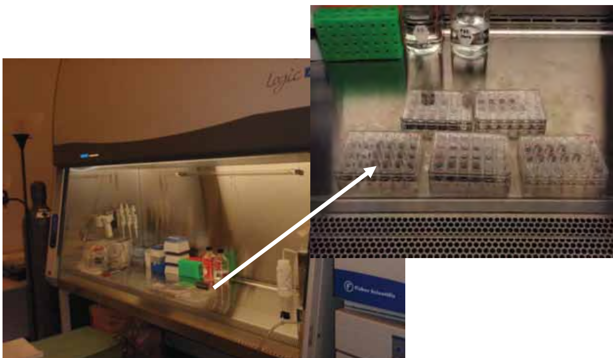
Figura 29 – Capela biológica com detalhe das placas de 24 poços empregadas para a cultura de célula contendo as amostras
