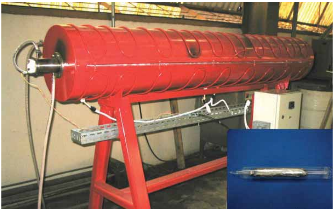
Figura 21 - Forno tubular usado para solubilização da liga Ti-30Ta (Detalhe do lingote encapsulado em tubo de quartzo)
