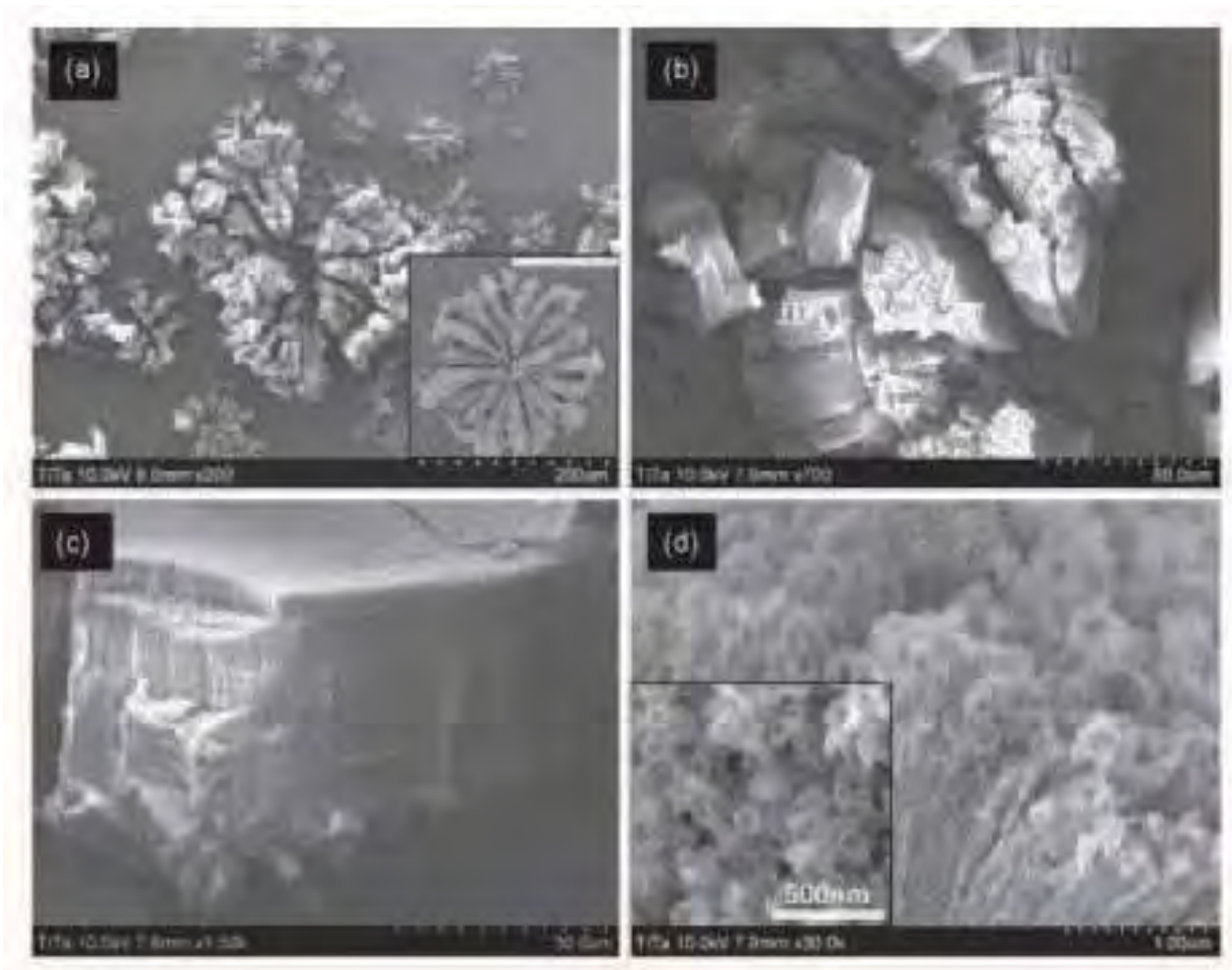
Figura 11- Imagens de MEV-FEG da liga Ti-35Ta após anodização em eletrólito composto por cloreto-perclorato. (a) menor aumento com imagem de flor, (b) imagem de menor aumento dos feixes de nanotubos, (c) imagem de nanotubos em bloco mostrando diversas camadas e d) imagem de maior aumento do bloco de nanotubos mostrando o topo com nanotubos organizados (adaptado de JHA;HAHN;SHMUKI, 2010)
