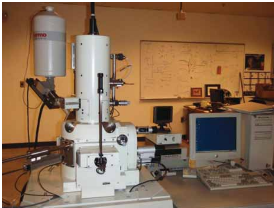
Figura 26- Microscópio eletrônico de varredura e EDS utilizada para investigar a superfície da liga Ti-30Ta anodizada
