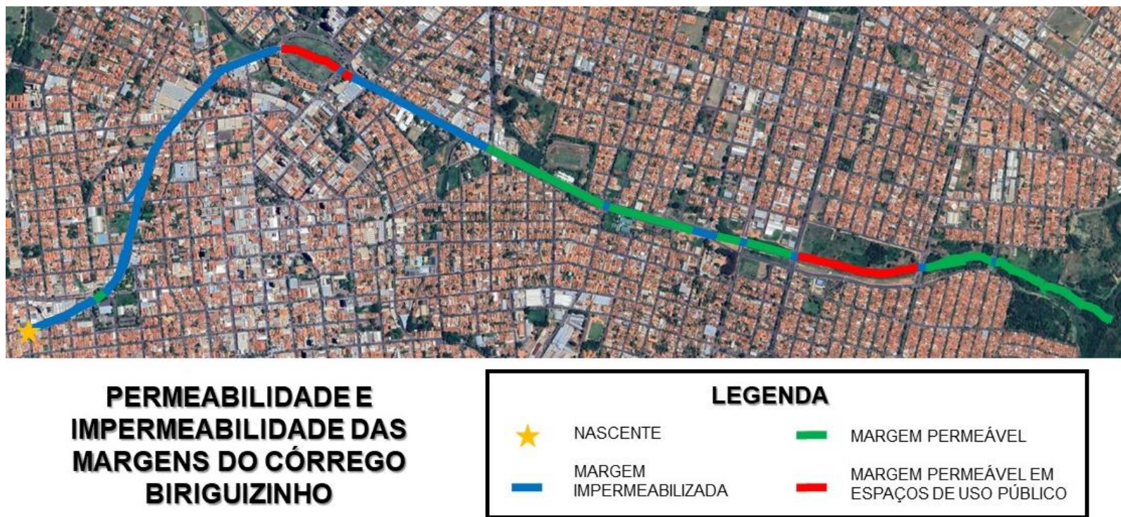
Figura 36: Percurso ao longo córrego: impermeabilização das margens.
