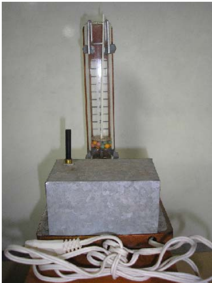
Fotografia – Experimento usado em sala de aula para demonstrar, por analogia, o comportamento das partículas de um gás.
