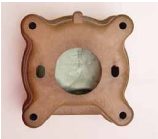
FIGURA 27 – Contra mufla posicionada para preenchimento com gesso.
