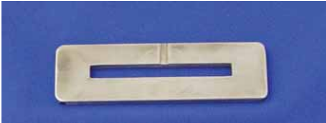
FIGURA 5 – Matriz com cavidade interna de 60X6X4 mm.
