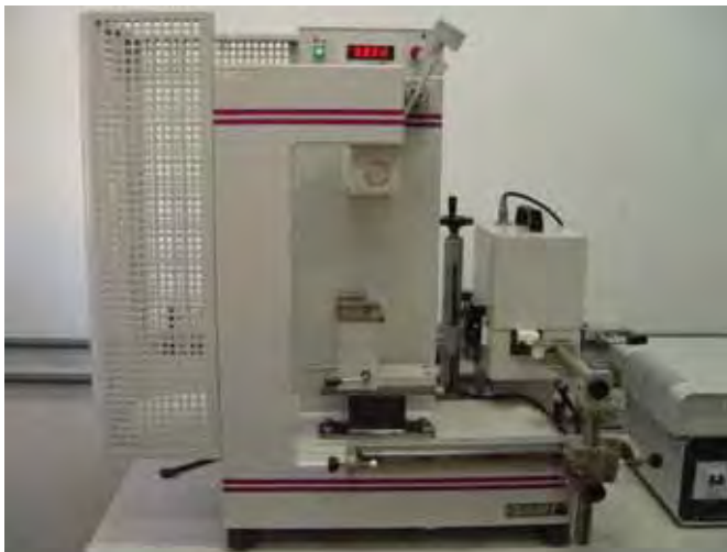
FIGURA 17 - Máquina de Resistência ao Impacto com pêndulo em seu ponto de repouso formando com o corpo-de-prova uma ângulo de 150^{\circ} .
