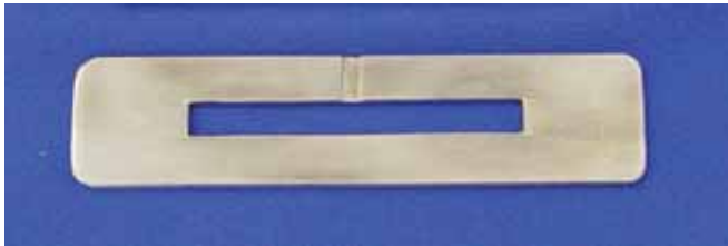
FIGURA 9 - Matriz com cavidade interna de 60X6X2.
