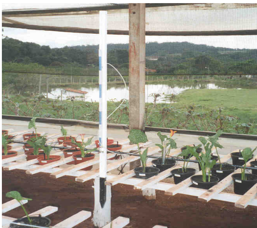
Figura 4. Detalhe da instalação do tensiômetro.
