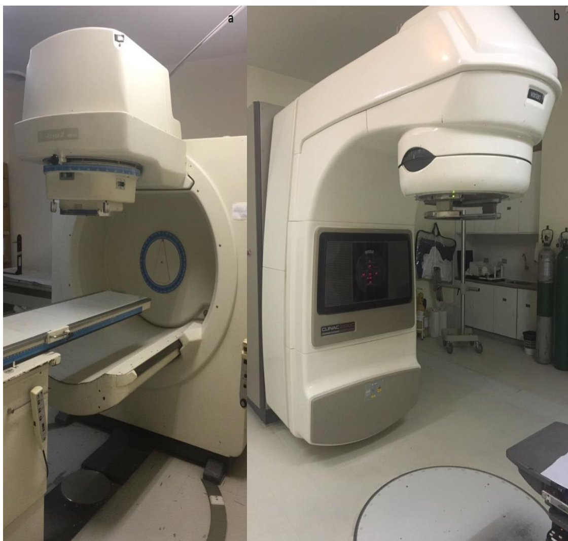
Figura 1 – Aparelhos de radioterapia do Hospital das Clínicas de Botucatu-SP a) Unidade de Cobalto-60; b) Acelerador linear.
