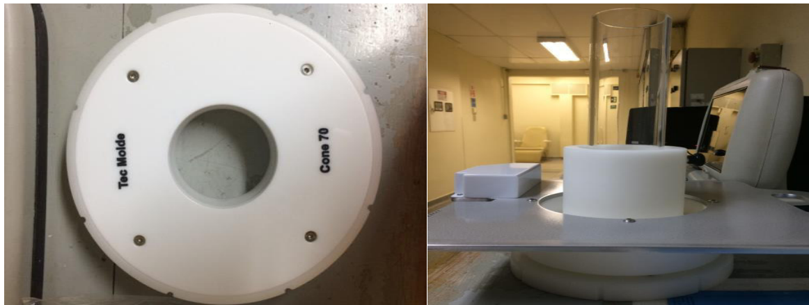
Figura 10 – a) Colimador; b) Sistema de cones localizadores
