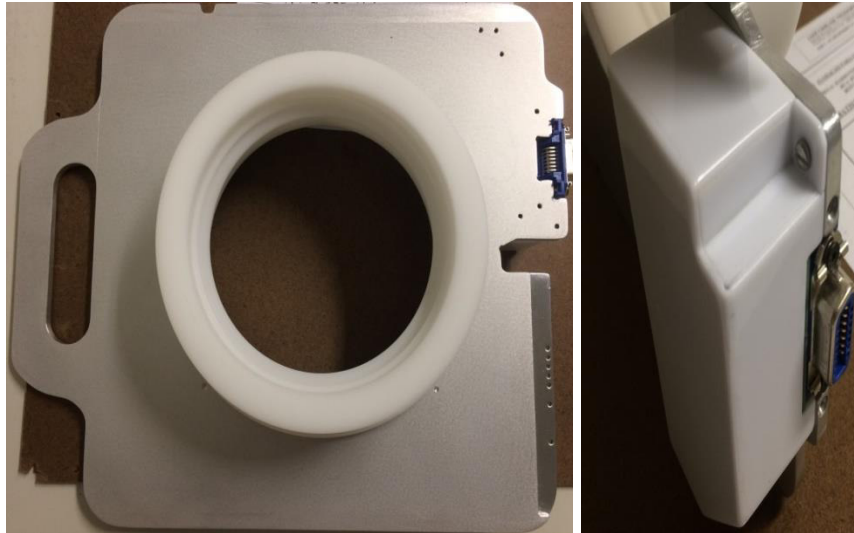
Figura 11 – a) Suporte de encaixe; b) Circuito para liberação do tratamento
