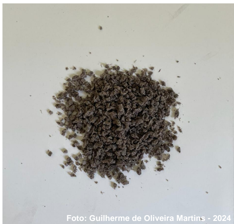
Figura 3 – Pellets depois do processo de extrusão.
