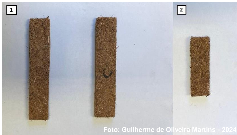
Figura 8 – Corpo de prova para os testes de flexão, absorção de água e inchamento.
