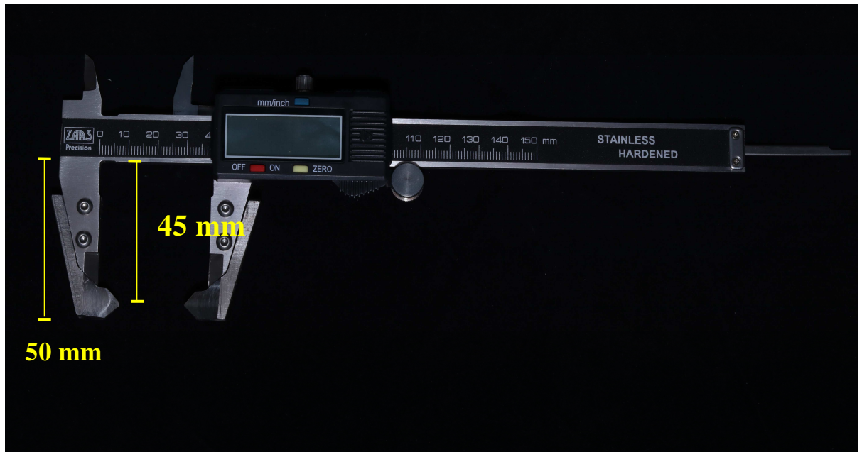
Figura 21 – Paquímetro com modificações e medidas, verificando a distância da régua principal até a ponta ativa das hastes medidoras externas
