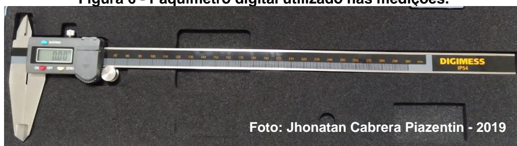
Figura 6 - Paquímetro digital utilizado nas medições.
