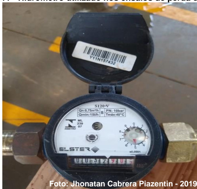
Figura 11 - Hidrômetro utilizado nos ensaios de perda de carga.
