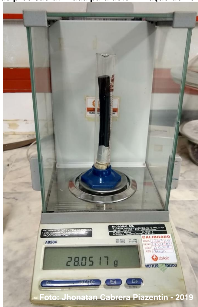
Figura 4 - Balança de precisão utilizada para determinação do volume de cada trecho.
