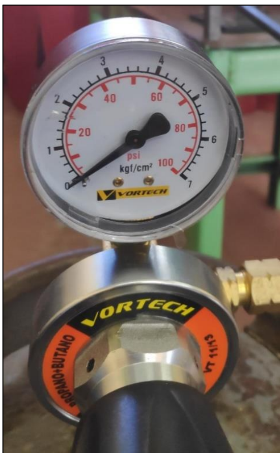
Figura 13- Regulador de pressão utilizado no processo OFW.
