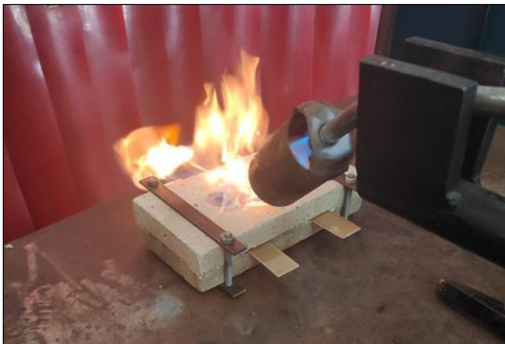
Figura 20 - Aplicação do dispositivo na soldagem por OFW.
