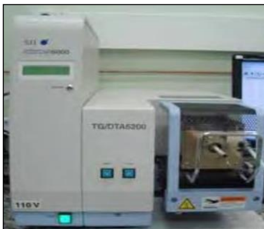
Figura 27 - Equipamento termogravimétrico SII Exstar 6000.
