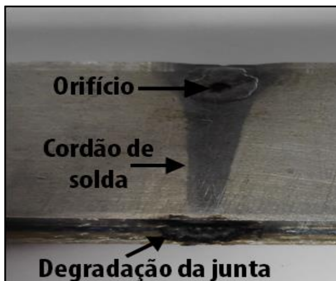
Figura 36 - Formação de keyhole com um tempo de aplicação de seis segundos.
