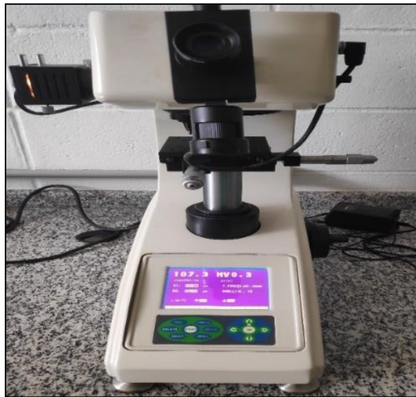
Figura 29 – Equipamento Wolpert 121 utilizado para determinação da dureza Vickers.
