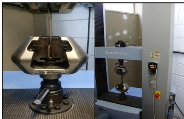
Figura 24 – Ilustração do ensaio de LSS para as amostras soldadas.
