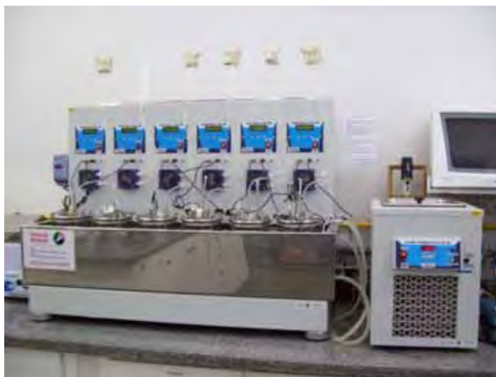
Figura 7 - Reator com seis vasos independentes para controle de pH
