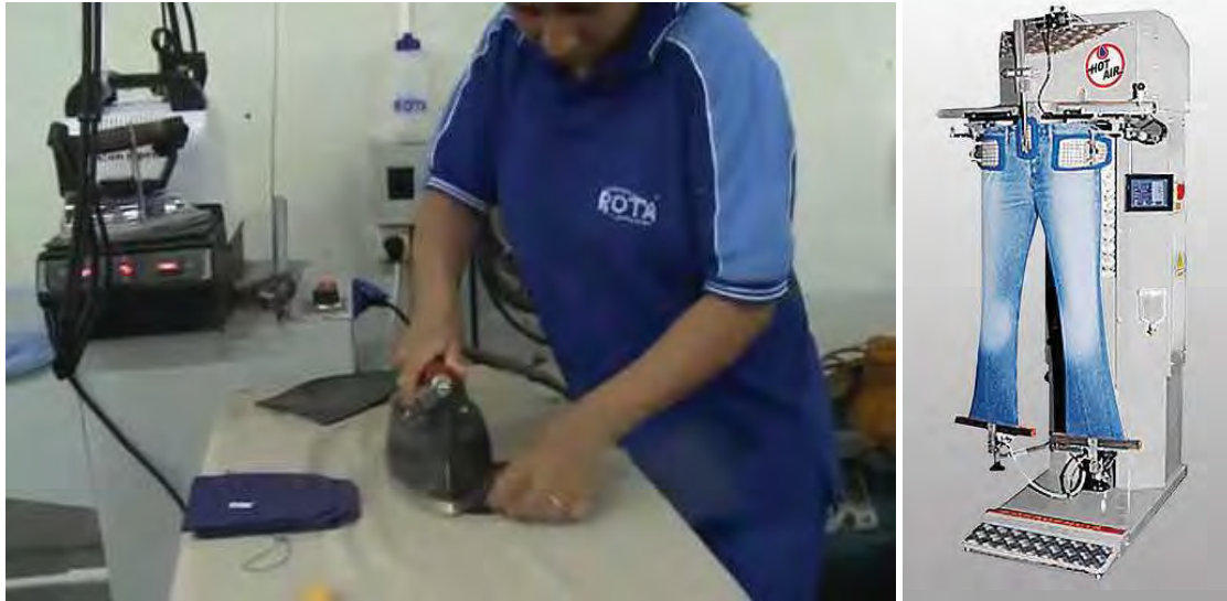
Figura 58: Passadoria manual e Figura 59: Passadoria à vapor, que passa de 100 a 150 calças por hora. Fonte: www.promovesc.com.br (2010), www.flickr.com (2010)
