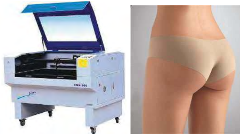
Figura 55: Máquina de corte a laser. Figura 56: lingerie cortada a laser, sem costuras.
