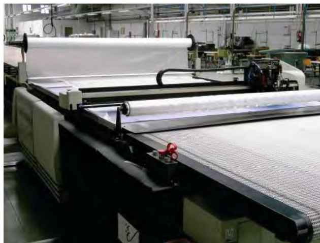
Figura 54: Mesa de enfiesto e corte eletrônico. Fonte: http://www.solostocks.com/ (2010)
