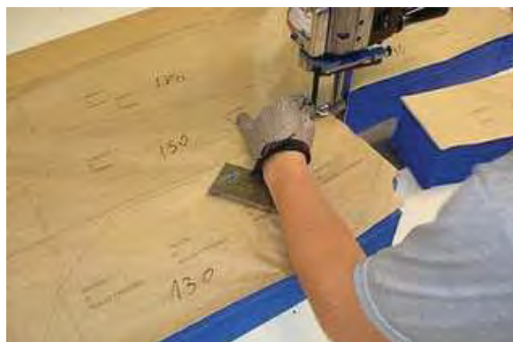
Figura 53: Corte manual com tesoura elétrica vertical. Neste caso, o equipamento é guiado, cortando o tecido. Fonte: http://robmaq.blogspot.com (2010)
