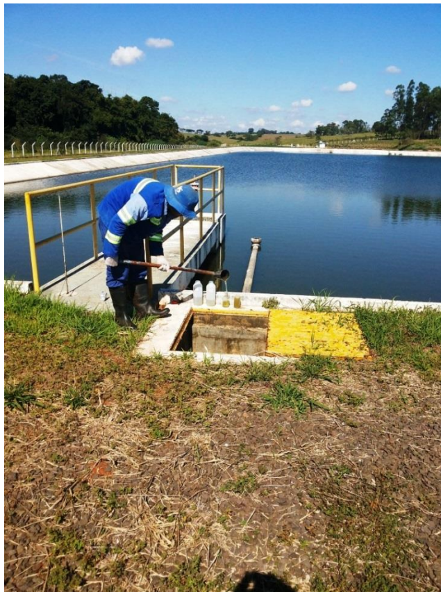
Figura 54- Coleta de esgotos para análise na saída da lagoa facultativa da ETE leste de Adamantina.
