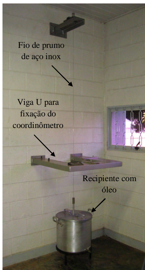
Figura 7: Simulação do esquema de instalação do pêndulo direto
