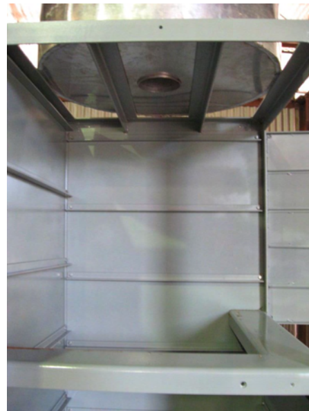
(b) Detalhe da base de leitura e apoio do recipiente de óleo
