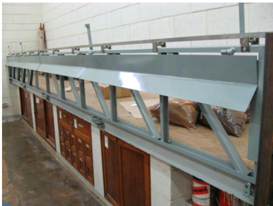
(a) Aparato de sustentação do laser
