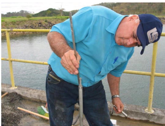
(e) Ajuste do apoio para relógio comparador
