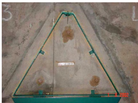
(b) Triangulação instalada em uma parede
