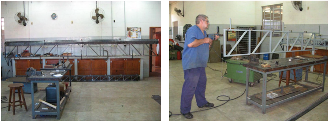
Figura 75: Confeção da viga metálica treliçada
