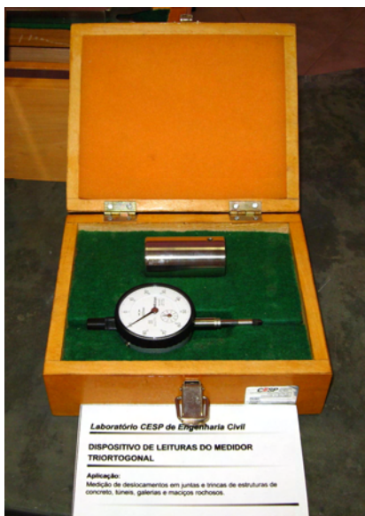
Figura 48: Dispositivo de leituras do medidor triortogonal
