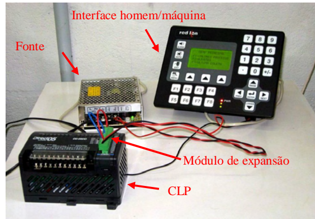
Figura 91: Componentes do sistema de aquisição de dados
