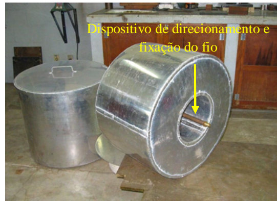
(b) Detalhe do flutuador. Ao fundo, recipiente com tampa
