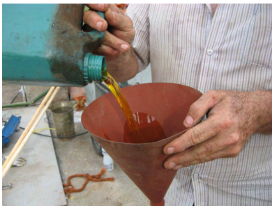
(c) Tubo de PVC sendo preenchido com lubrificante
