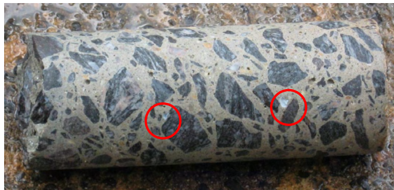
Figura 35: Poros do concreto preenchidos com material de reação
