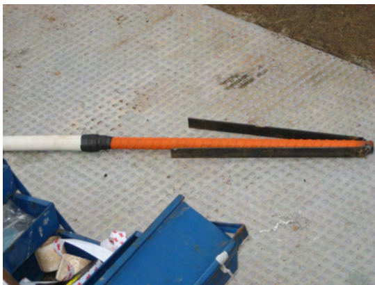
(a) Chumbador das hastes fixo no PVC
