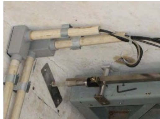
(d) LVDT fixo na barra invar
