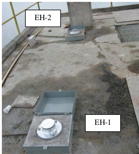
Figura 69: Extensômetros múltiplos de hastes instalados
