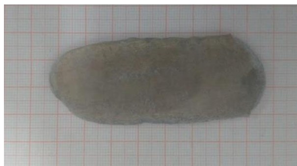
Figura 13 – Lingotes da liga Ti-5Mo, após a laminação.
