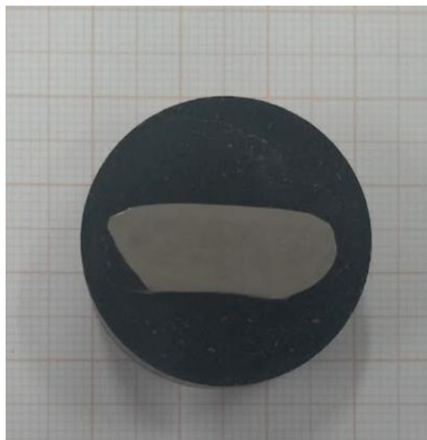
Figura 18 - Amostra da liga Ti-5Mo embutida em baquelite.
