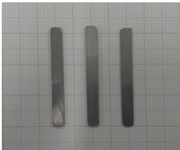
Figura 22 - Amostras da liga Ti-5Mo cortadas em lâmina para medidas de módulo de elasticidade.
