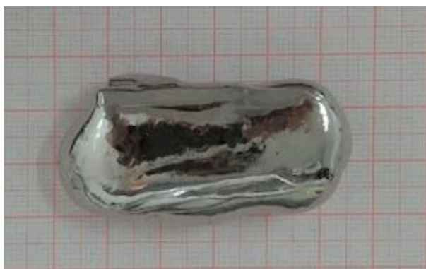
Figura 8 - Lingote da liga Ti-5Mo produzido por fusão à arco voltaico.
