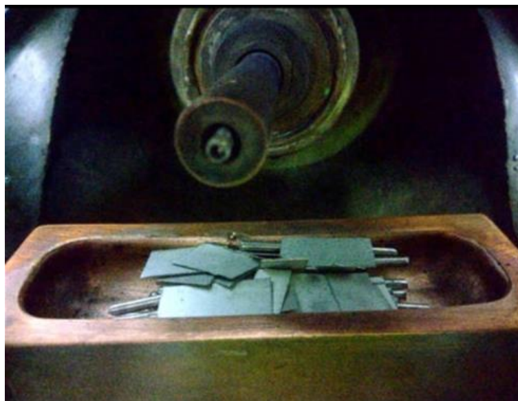
Figura 7 - Materiais precursores no cadinho de cobre.
