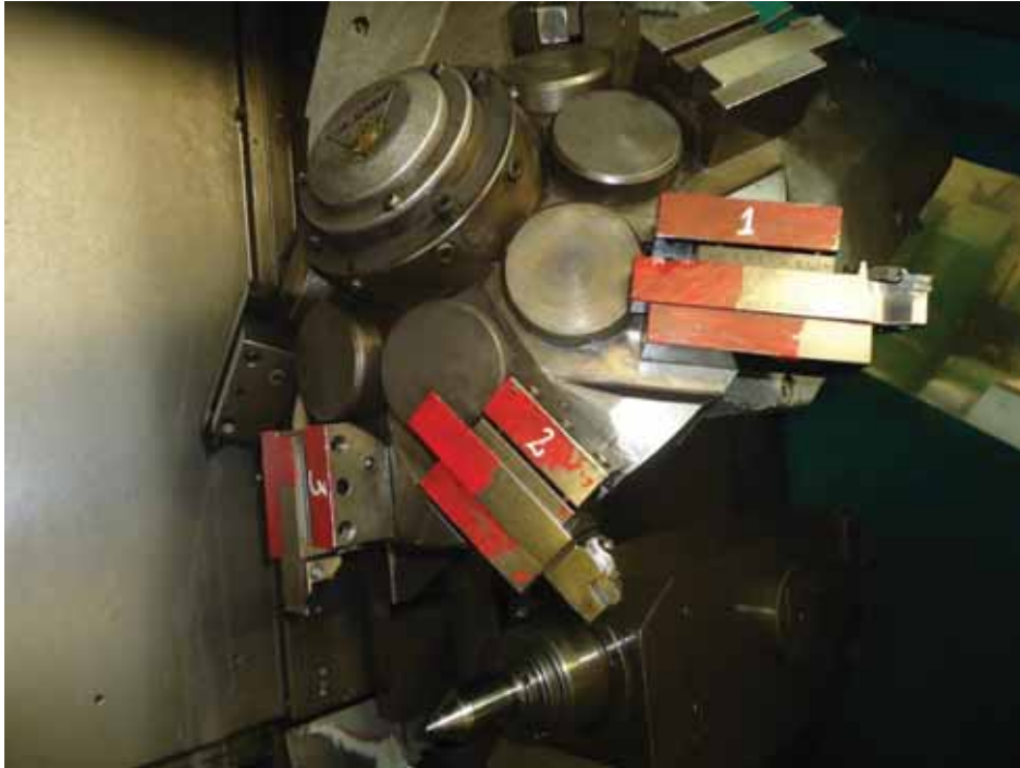
FIGURA 17- Dispositivo com ferramentas identificadas pela etiqueta.
