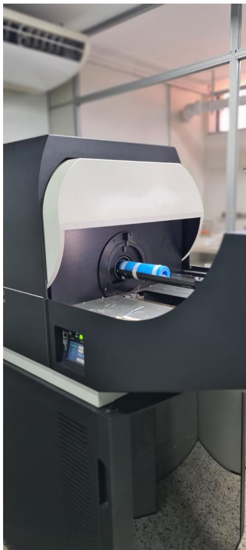
Figura 7 - microtomógrafo SkyScan 1172 (Kontich, Bélgica) usado para a realização das microtomografias
