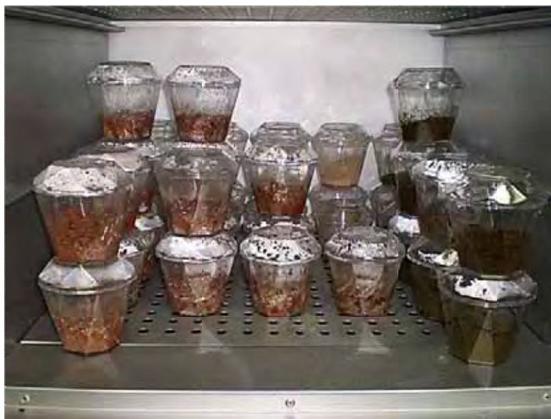
FIGURA 2 - Procedimento para a fermentação do substrato em estufa a 30 \pm 2^\circ\text{C} .
