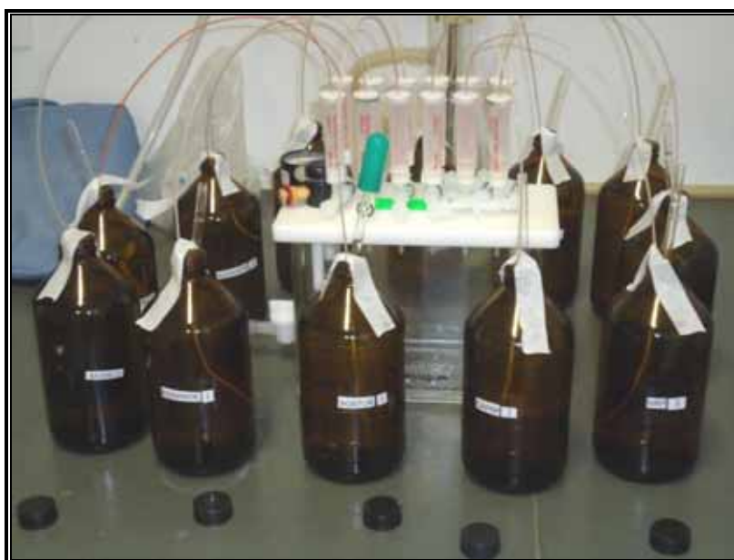
Figura 07: Sistema de SPE com manifold utilizado na extração e pré-concentração das amostras de água.
