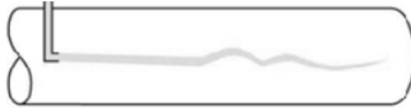
Figura 4 - Esquema de um escoamento de transição.
