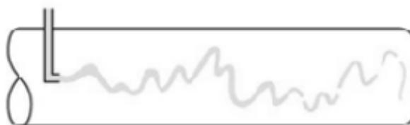
Figura 3 - Esquema de um escoamento turbulento.
