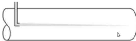
Figura 2 - Esquema de um escoamento laminar
