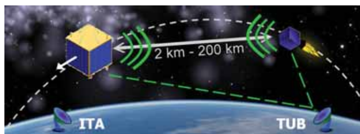
Figura 8 - Imagem ilustrativa do funcionamento do experimento Fox-ISL. Fonte: ITASAT
