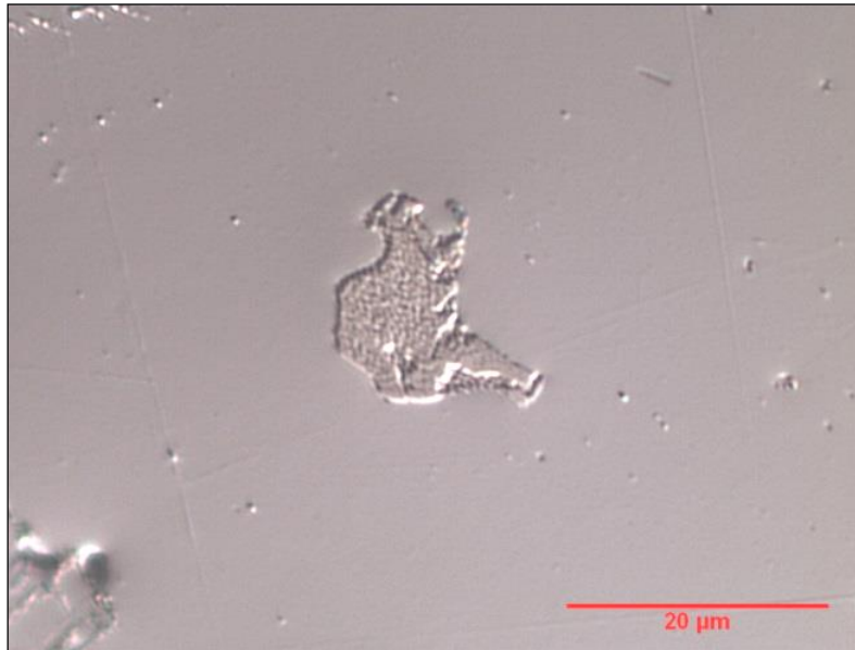
Figura 29 – Precipitado Mg_5Al_8 , a 2,5mm da superfície de laminação. Aumento 500x escala 20 \mu m .
