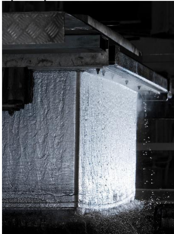
Figura 7 – Vazamento de placa no processo DC
